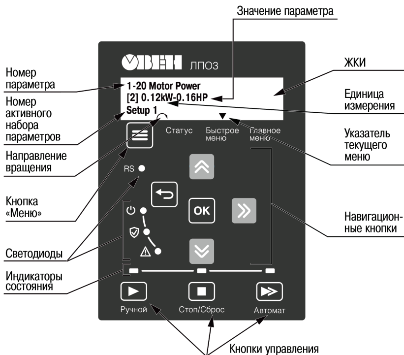
Рисунок 3.4 – ЛПОЗ – Локальная панель оператора ПЧВЗ. Элементы индикации и управления
