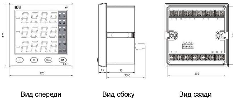
Рисунок 3.1 – Внешний вид и размеры прибора PD194PQ-2K4T
