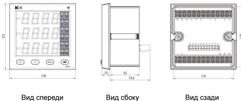
Рисунок 3.2 – Внешний вид и размеры прибора PD194PQ-2S4T
