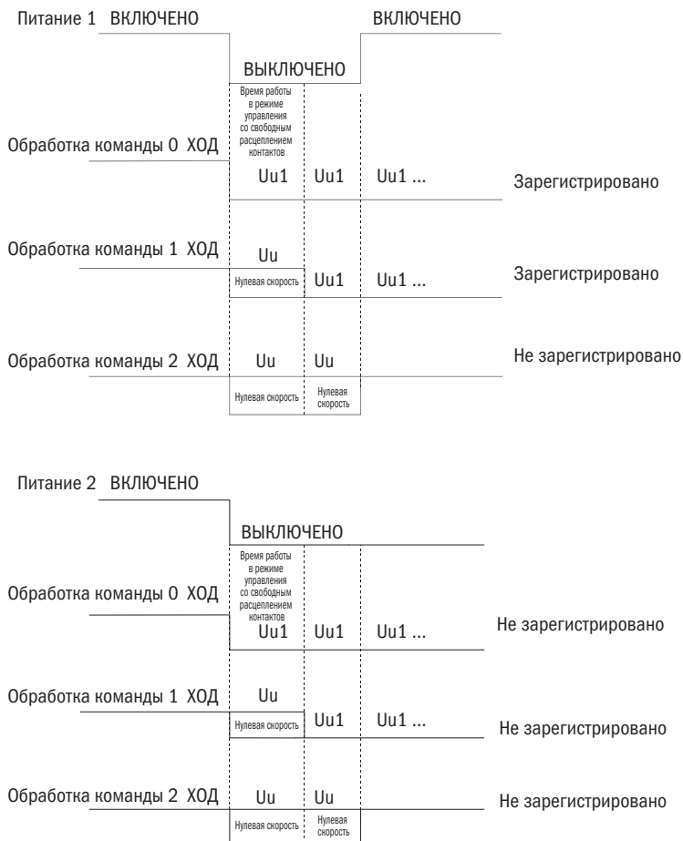
Рисунок 5-8. Рисунок работы со свободным расцеплением контактов
