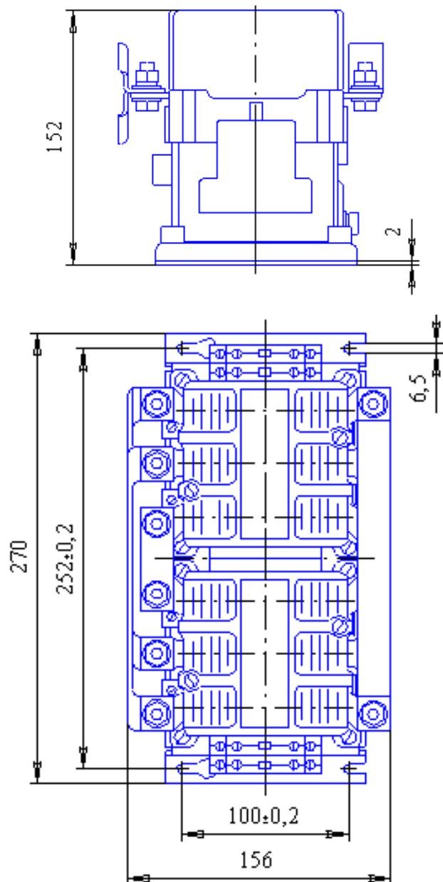
**Рис. 3 - Контактор электромагнитный
