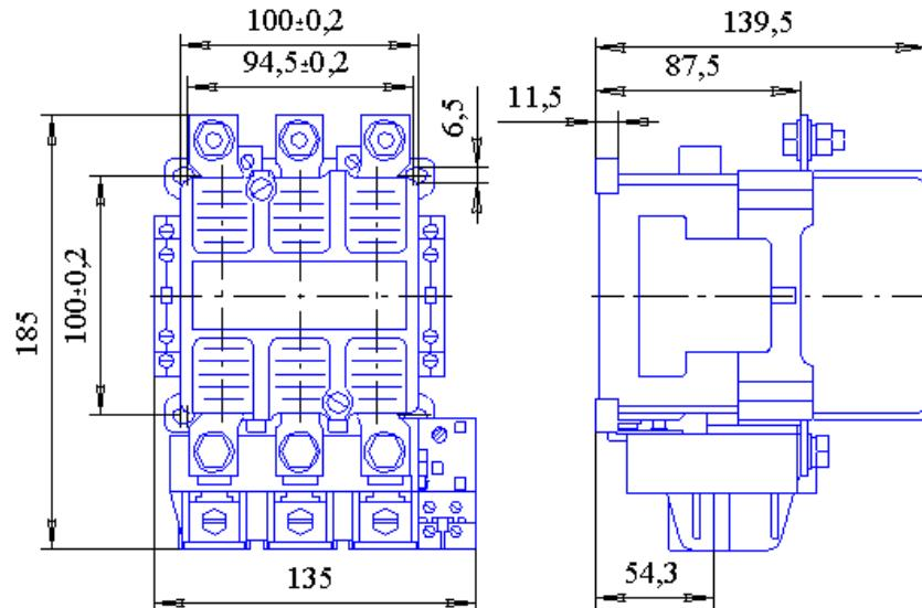
Рис. 2 - Пускатель электромагнитный типа ПМ12-125200
