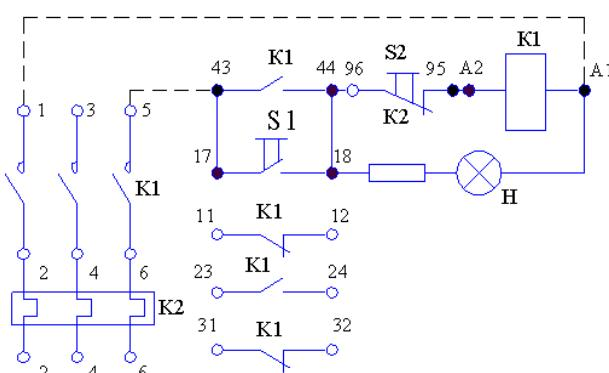
Рис. 6 - Схемы электрические принципиальные контакторов и пускателей
