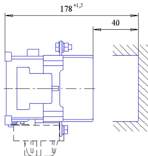
**Рис.9 - Опасная зона выхлопа дугогасительной камеры контакторов и пускателей.**
