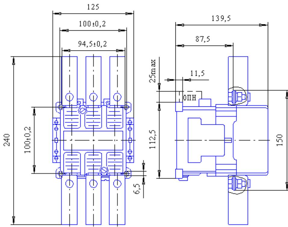
Рис. 1 - Контакторы электромагнитные типа ПМ12-125100, ПМ12-125150
