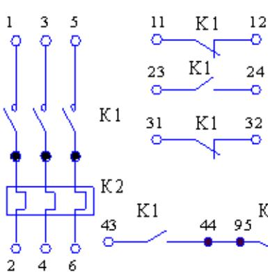
е) Контакторы нереверсивные степеней защиты IP40, IP54 с кнопками «Пуск» и «Стоп»
