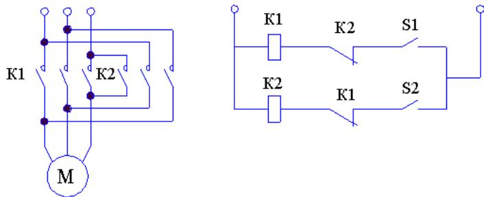
K1 и K2 - испытуемые контакторы и пускатели
