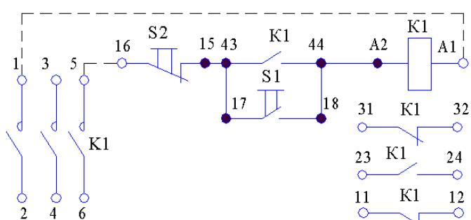
з) Пускатели нереверсивные степеней защиты IP40, IP54 с кнопками «Пуск» и «Стоп» и сигнальной лампой
