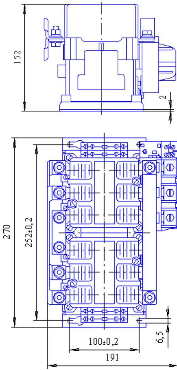
**Рис. 4 - Пускатель электромагнитный
