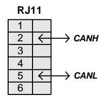
Разводка вилки терминатора сети RS-485
