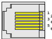
Ниже светодиода “PWR/TX” расположены два 6-контактных телефонных разъема последовательных интерфейсов. Нумерация выводов разъемов приведена на рисунке.
