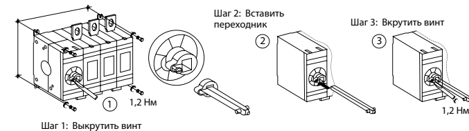
Рис. 7 - Установка переходника
