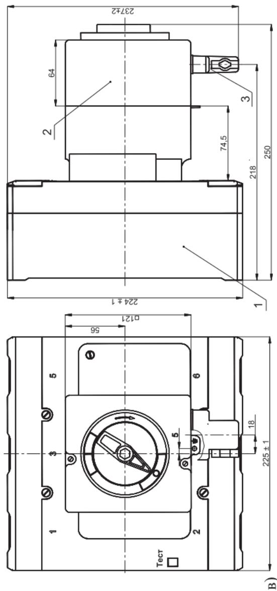
1 – выключатель; 2 – привод электромагнитный; 3 – соединитель типа РП10
