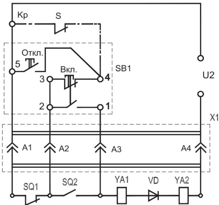
**Рисунок В.2** - Электрическая принципиальная схема привода электромагнитного
