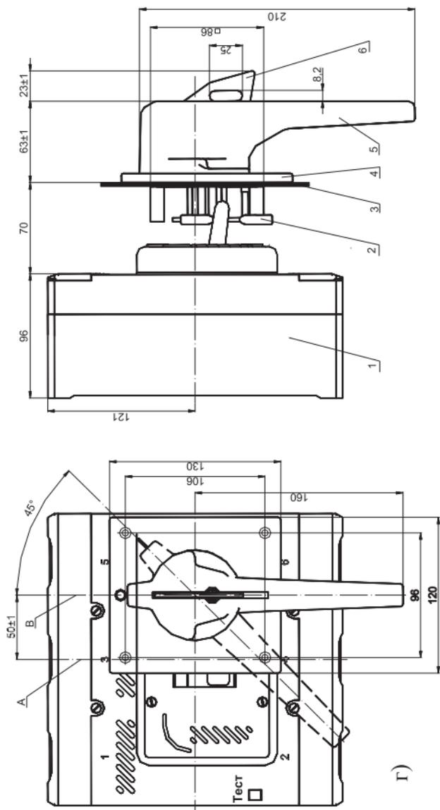
А – вертикальная ось выключателя, В – вертикальная ось ручного дистанционного привода.
