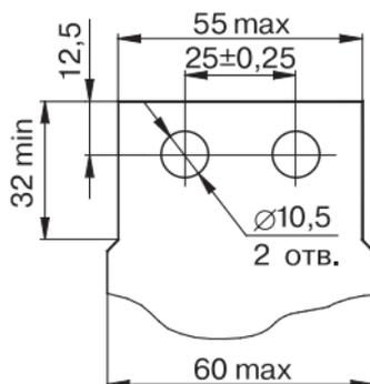
**Рисунок 2** - Форма и размеры присоединяемой шины максимального сечения
