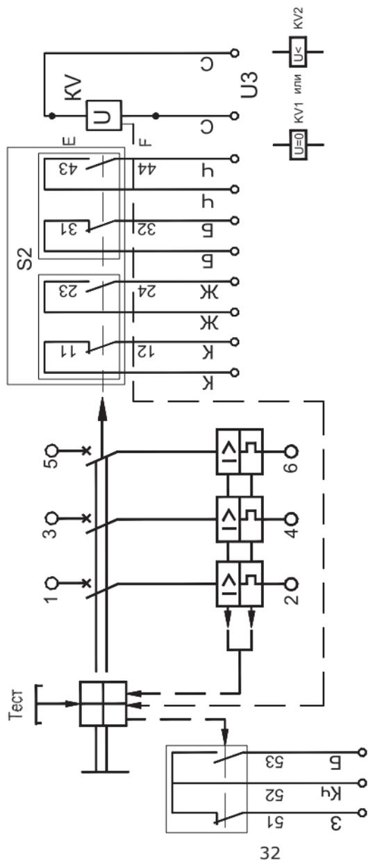
**Рисунок В.4** – Выключатель с нулевым или минимальным распределителем напряжения, вспомогательными контактами сигнализации автоматического отключения и вспомогательными контактами
