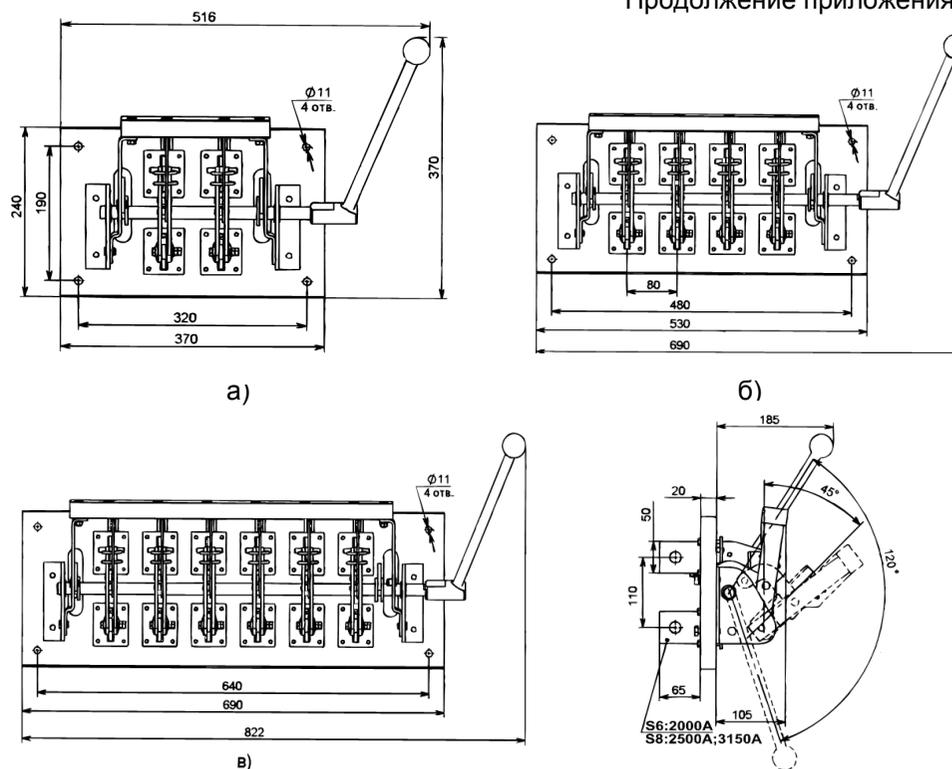
Рис. 52Б Разъединитель PE19 с боковой рукояткой, заднего присоединения шин
