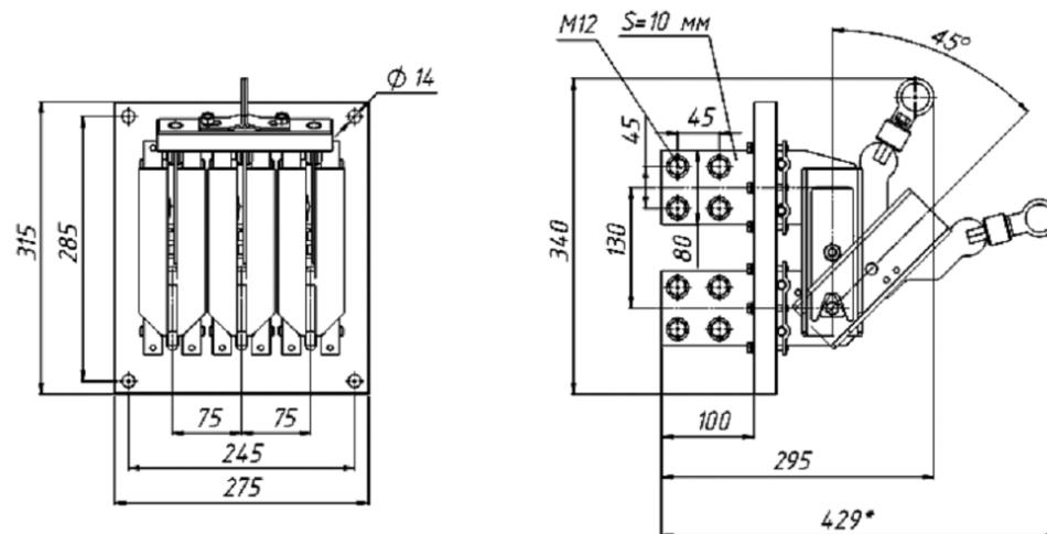
Рис. 55Б Разъединитель PE19 с центральным рычагом для управления штангой PE19-49-12290-00 УХЛ3
