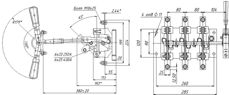
Разметка отверстий для установки привода
