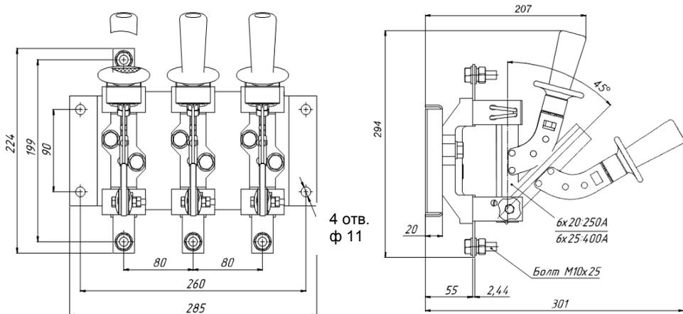
Рис.5Б Разъединитель PE19-35(37)-31170-00 УХЛ3
