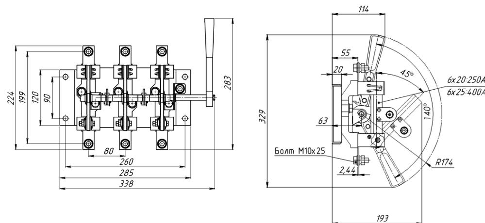
Рис.7Б Разъединитель PE19-35(37)-31120-00 УХЛЗ с боковой рукояткой
