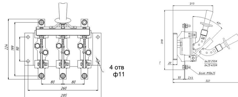
Рис.3Б Разъединитель PE19-35(37)-21110-00 УХЛЗ трехполюсный с центральной рукояткой
