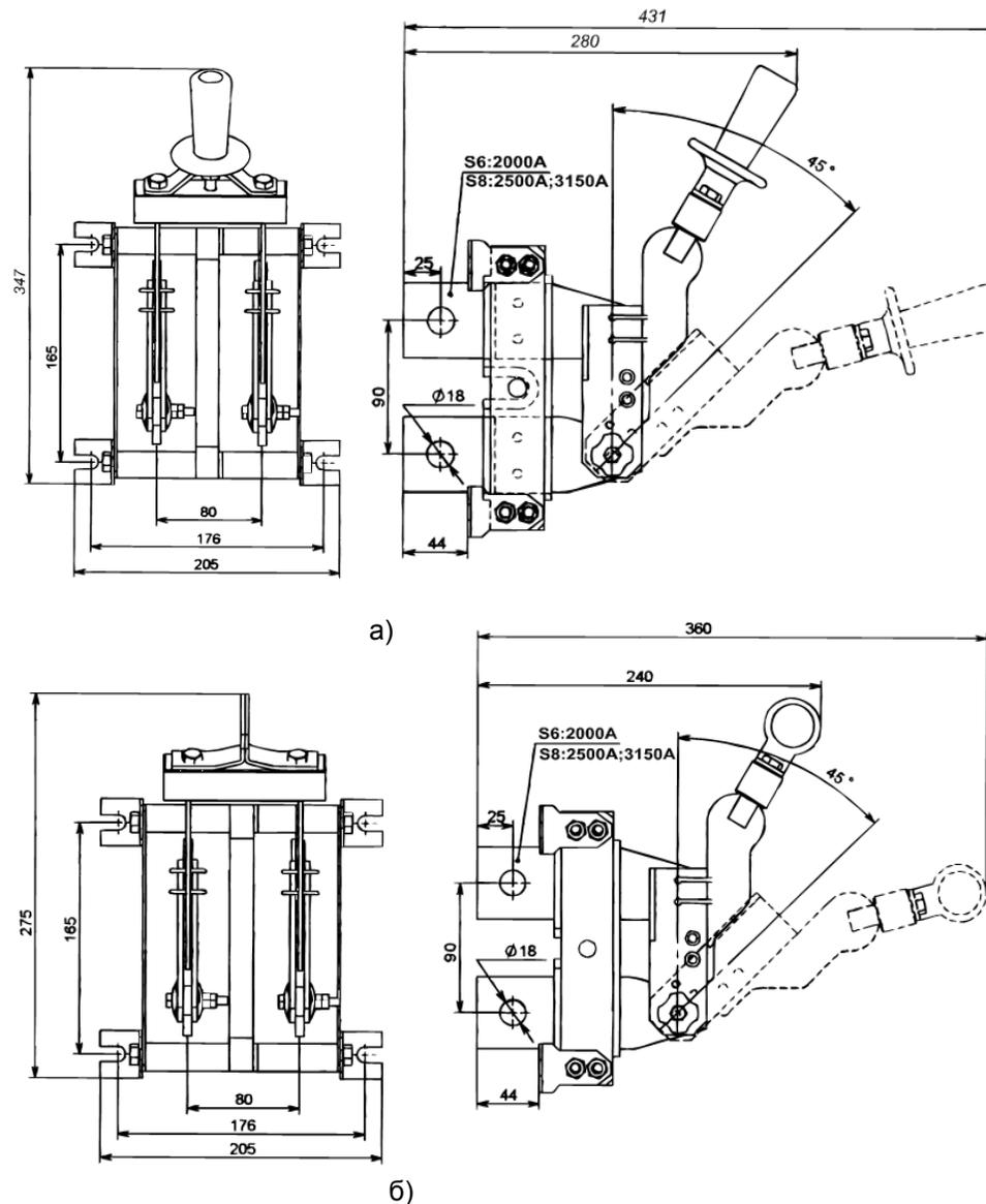
Рис. 45Б Разъединитель PE19 однополюсный, заднего присоединения шин
