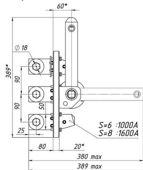
Разметка отверстий для установки фланца
