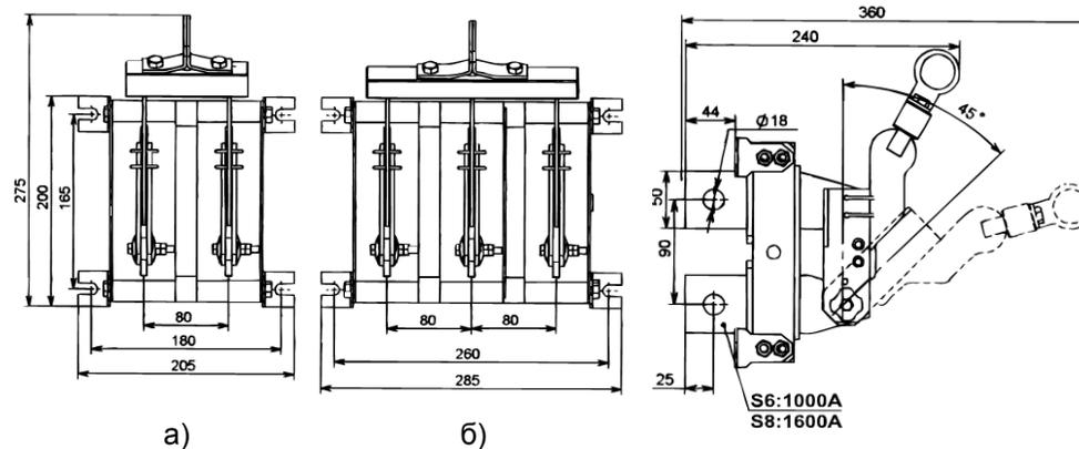
Рис.32Б Разъединитель PE19 с центральным рычагом для управления штангой, заднего присоединения шин
