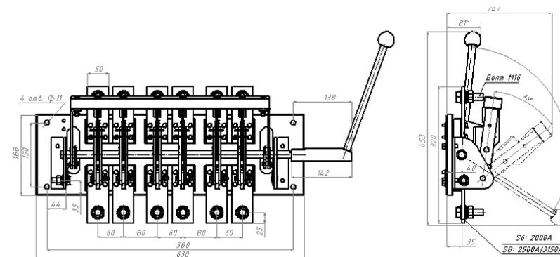
Рис. 51Б Разъединитель PE19 с боковой смещенной рукояткой
