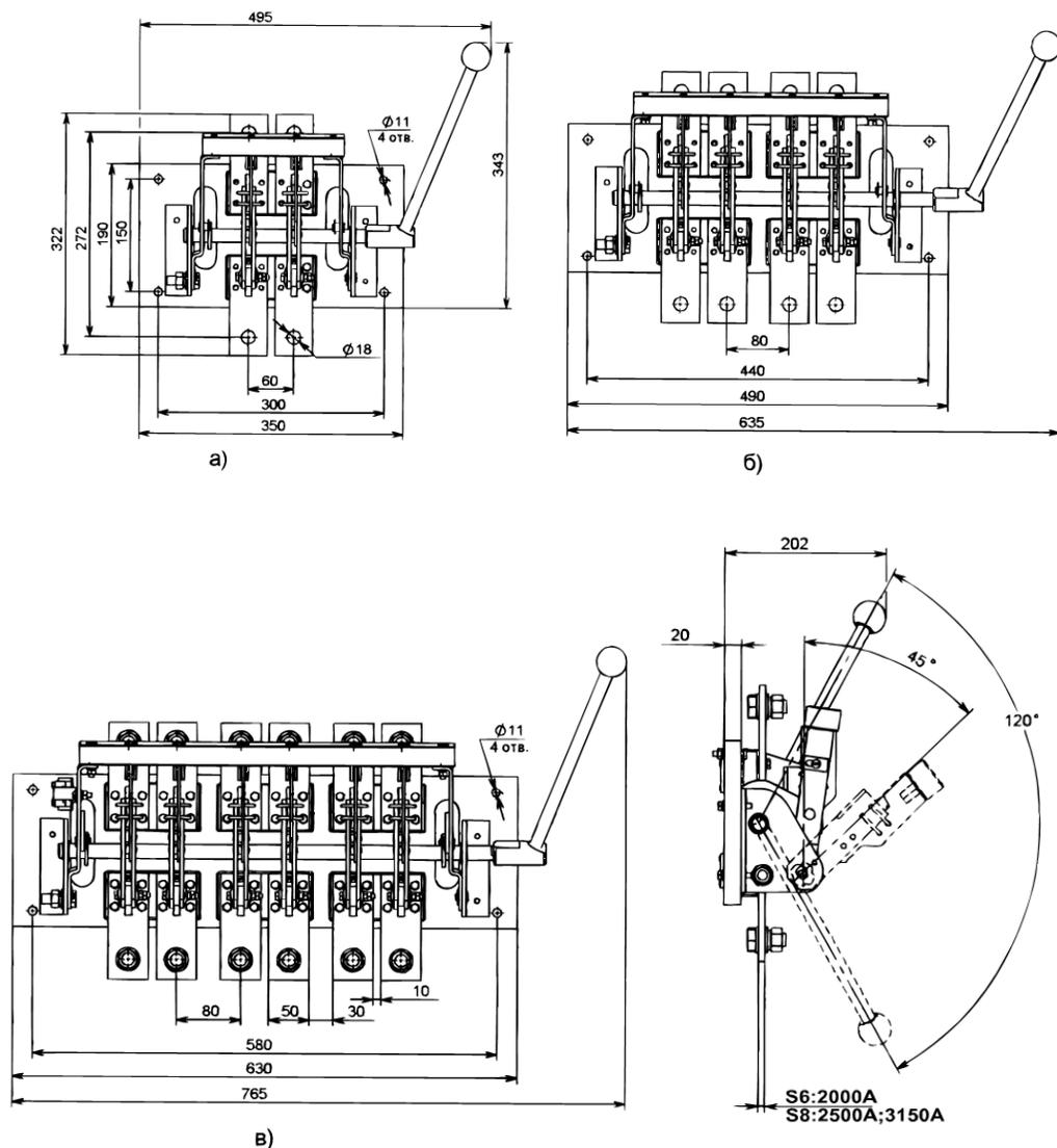
Рис. 50Б Разъединитель PE19 с боковой рукояткой,
