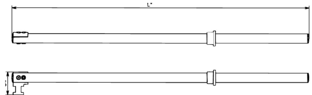
Рис.31Б Разъединитель PE19 с центральной рукояткой,
