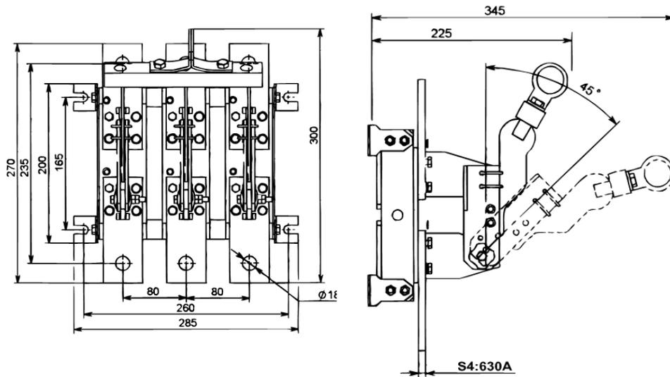
Рис.9Б Разъединитель PE19-39-31190-00 УХЛ3 с центральной штангой
