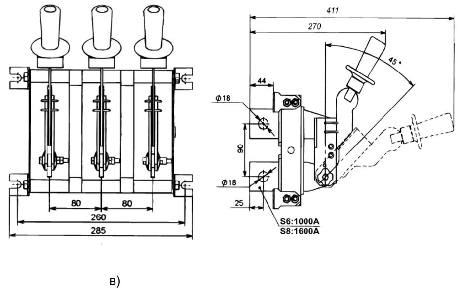
Рис.22Б Разъединитель PE19 с рычагом для полюсного оперирования штангой
