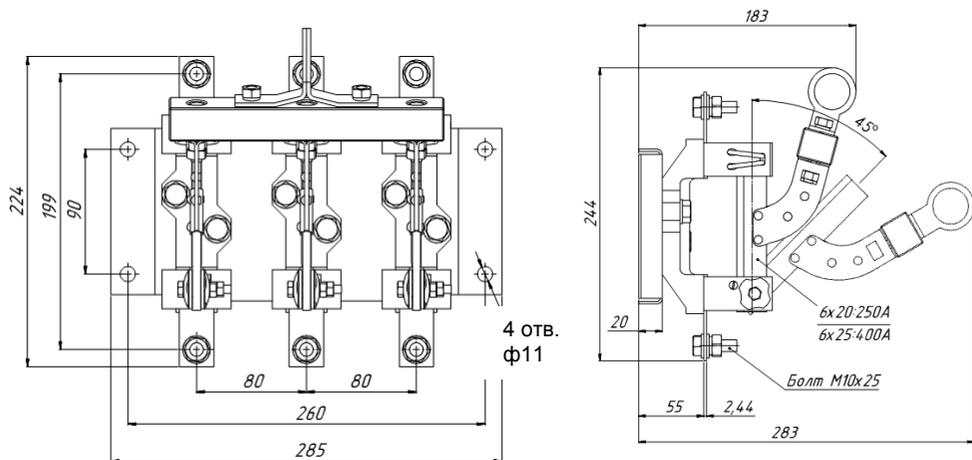
Рис.4Б Разъединитель PE19-35(37)-31190-00 УХЛ3
