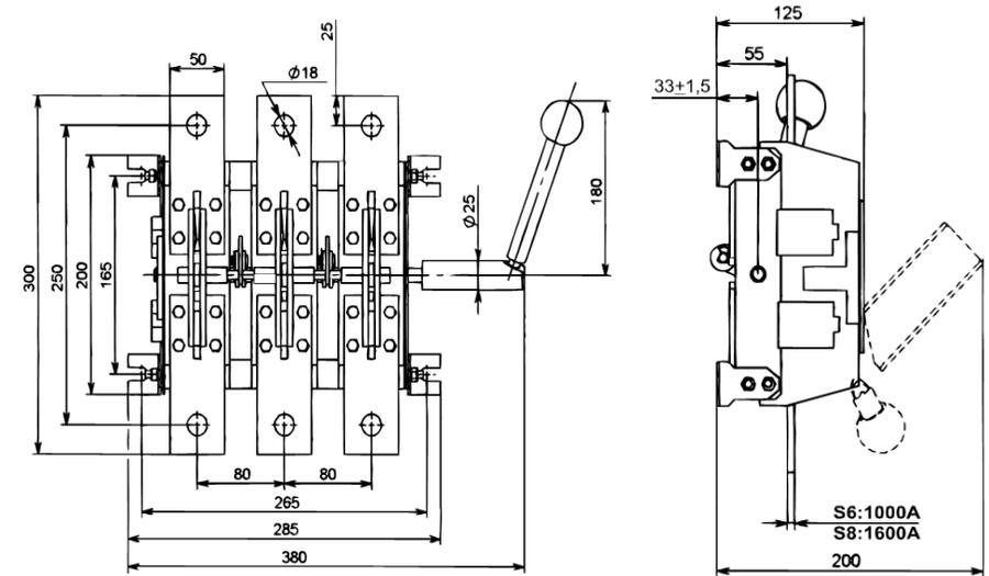
Рис.30Б Разъединитель PE19 с центральным рычагом для управления штангой,
