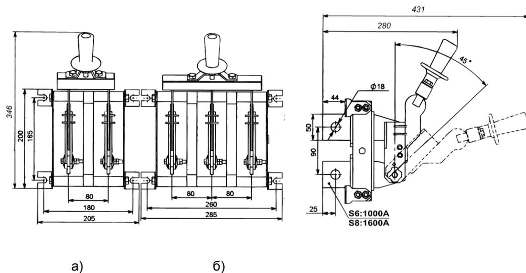
Рис.33Б Разъединитель PE19 с центральной рукояткой, заднего присоединения шин
