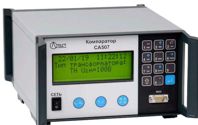
Компаратор **CA507** предназначен для использования в качестве устройства сравнения при проведении поверки (калибровки) трансформаторов тока (ТТ) и трансформаторов напряжения (ТН), а также для измерения параметров нагрузок во вторичной цепи ТТ и ТН
