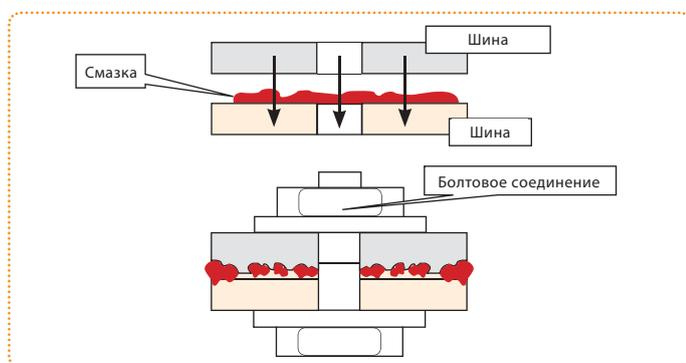
Места соединения медных шин обрабатываются токопроводящей пастой для улучшения токопоедачи
