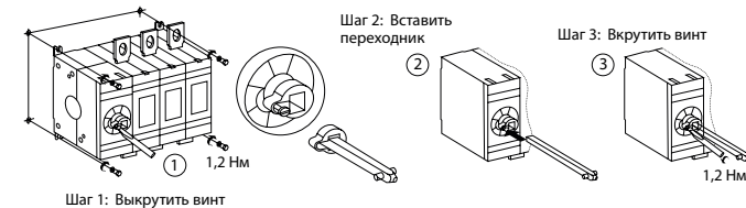
Рис. 7 - Установка переходника
