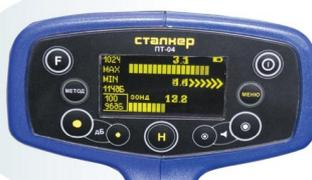
Точное определение мест повреждения изоляции совместно с локализацией оси коммуникации.
