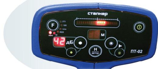
точное определение положения оператора относительно оси трассы при помощи индикатора “влево/вправо”
