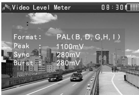
Тестер, применяя аппаратную высокоскоростную технологию выборки и обработки, может выполнять измерения амплитуды сигнала NTSC и PAL от уровня PEAK до уровня PEAK, SYNC и уровня вспышки цветности COLOR BURST. Когда аналоговый сигнал поступает в тестер, тестер отображает измерения в левом нижнем углу экрана.
