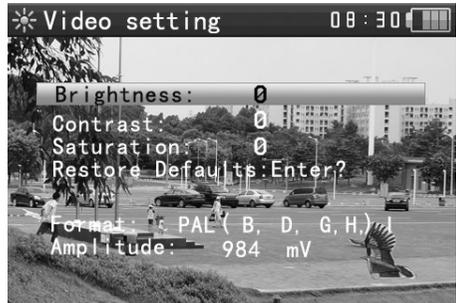
Вы можете регулировать яркость, контрастность, насыщенность цвета. Тестер автоматически отображает формат (PAL / NTSC) видеовхода и анализирует уровень входного видеосигнала.
