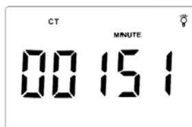
**Измерение текущего потребления тока.** . Нажмите клавишу ▲ или ▼ для переключения в режим измерения текущего потребления тока "CUR". Измеряемый диапазон составляет до 10А. При токах меньше 1А, единицы измерения автоматически переключаются в мА(мкА)
