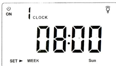
Шаг 2: Когда время включения и выключения первого таймера настроены, вы можете перейти к настройке 2-ой группы времени и даты включения и выключения. 20 групп данных включения и выключения должны соответствовать друг другу.
