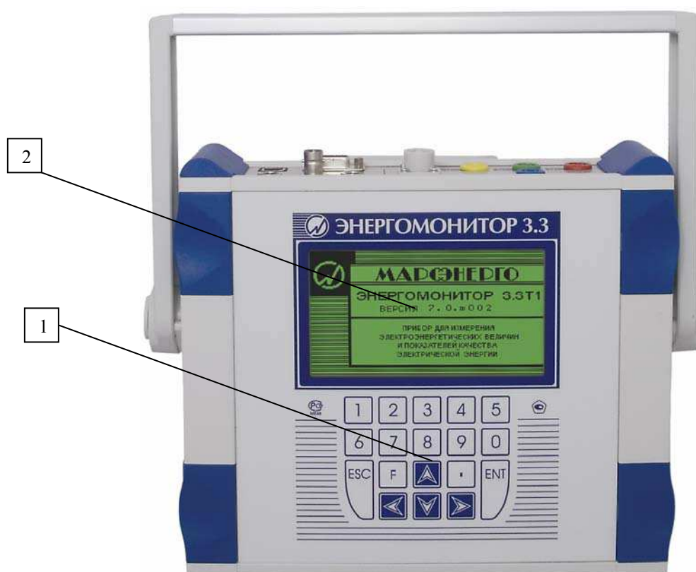
Рисунок 2.1 Лицевая панель прибора «Энергомонитор-3.3Т1» 1 – клавиатура; 2 – дисплей.
