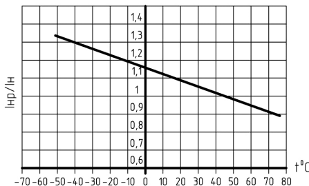
Рисунок А.8 - Зависимость номинального рабочего тока выключателей с приемкой РС от температуры окружающего воздуха
