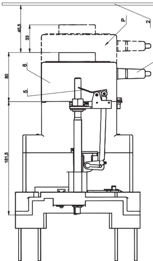
1 - выключатель; 2 - дверь распределительного устройства; 3 - привод ручной дистанционный; 4 - соединитель типа РП10; 5 - блокировка; 6 - привод электромагнитный;
