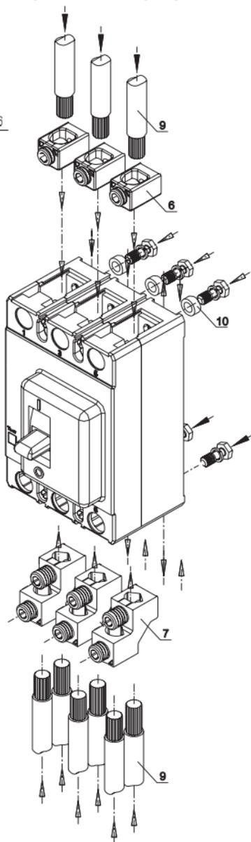
Таблица Д.1 - Варианты способов присоединения проводников выключателя
