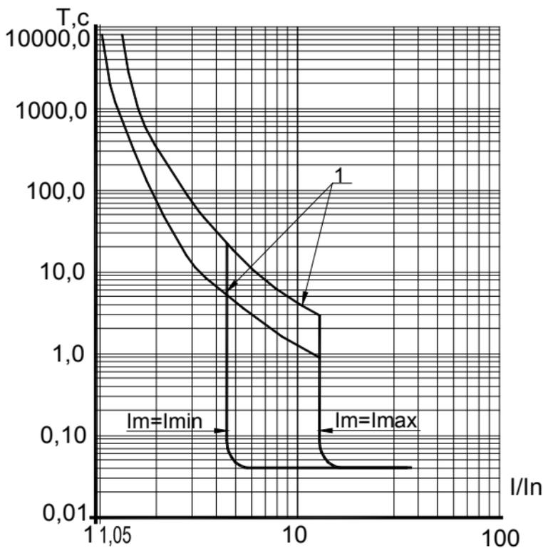
1 – зона работы максимального расцепителя тока перегрузки;
