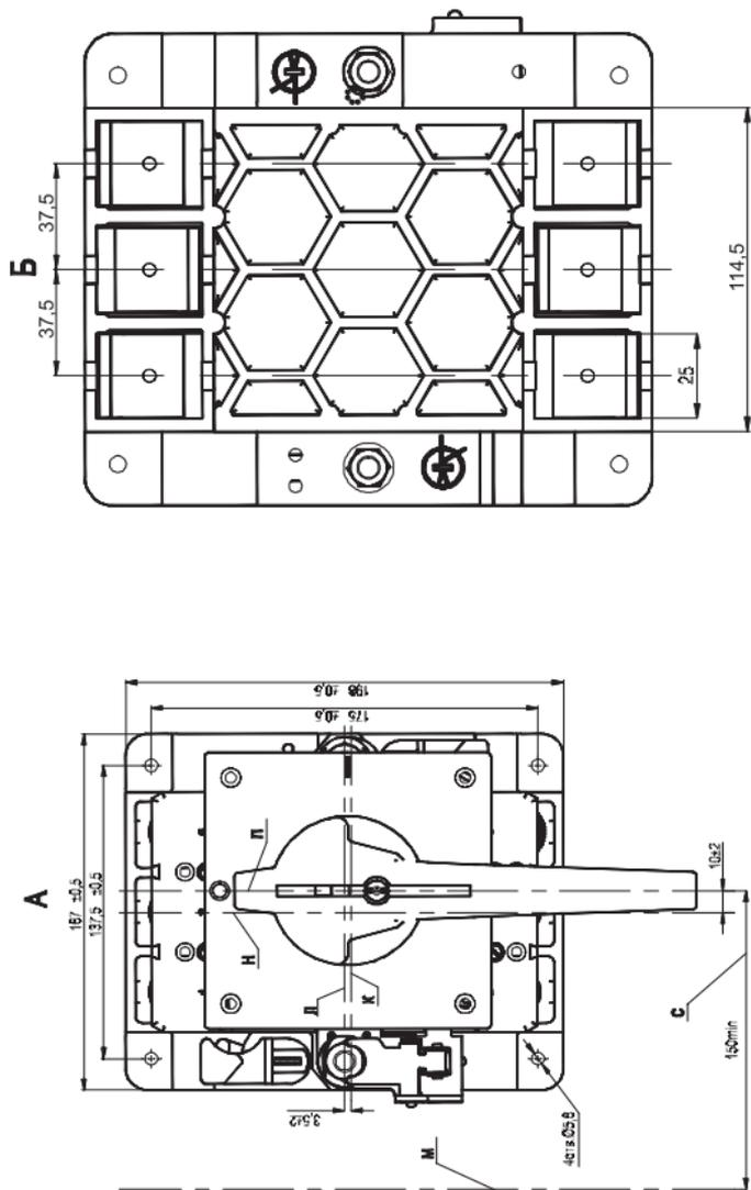
**РИСУНОК Б.7** - Выключатель ВА57-35 выдвигного исполнения с ручным дистанционным приводом
