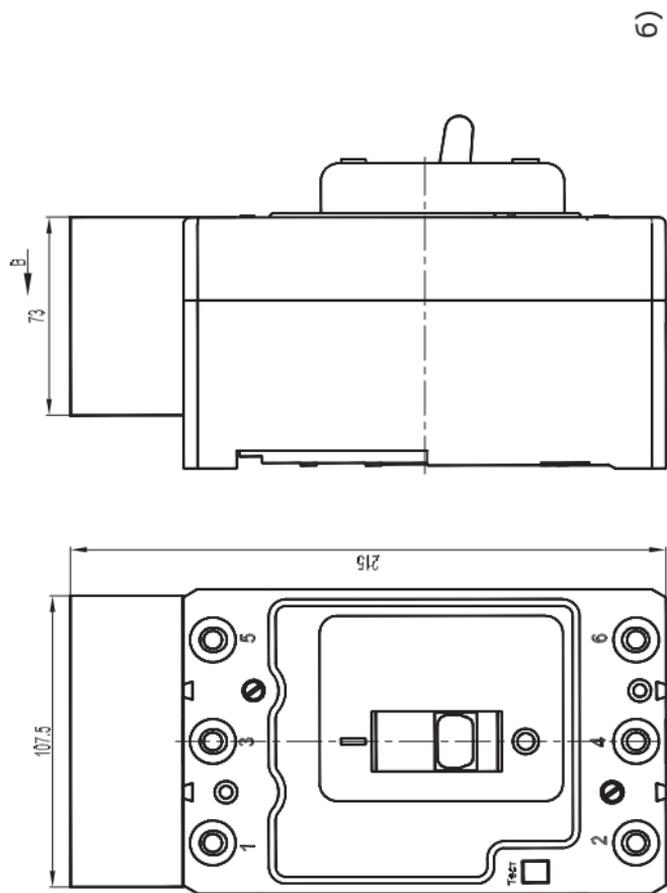
а) выключатель; б) выключатель BA57-35 с клеммной крышкой
