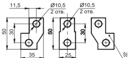
**Рисунок Д.2** - Комплект дополнительных расширительных соединительных выводов
