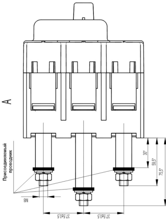
**Рисунок Б.2** - Выключатели ВА57-35 (ВА57Ф35) с зажимами для заднего присоединения
