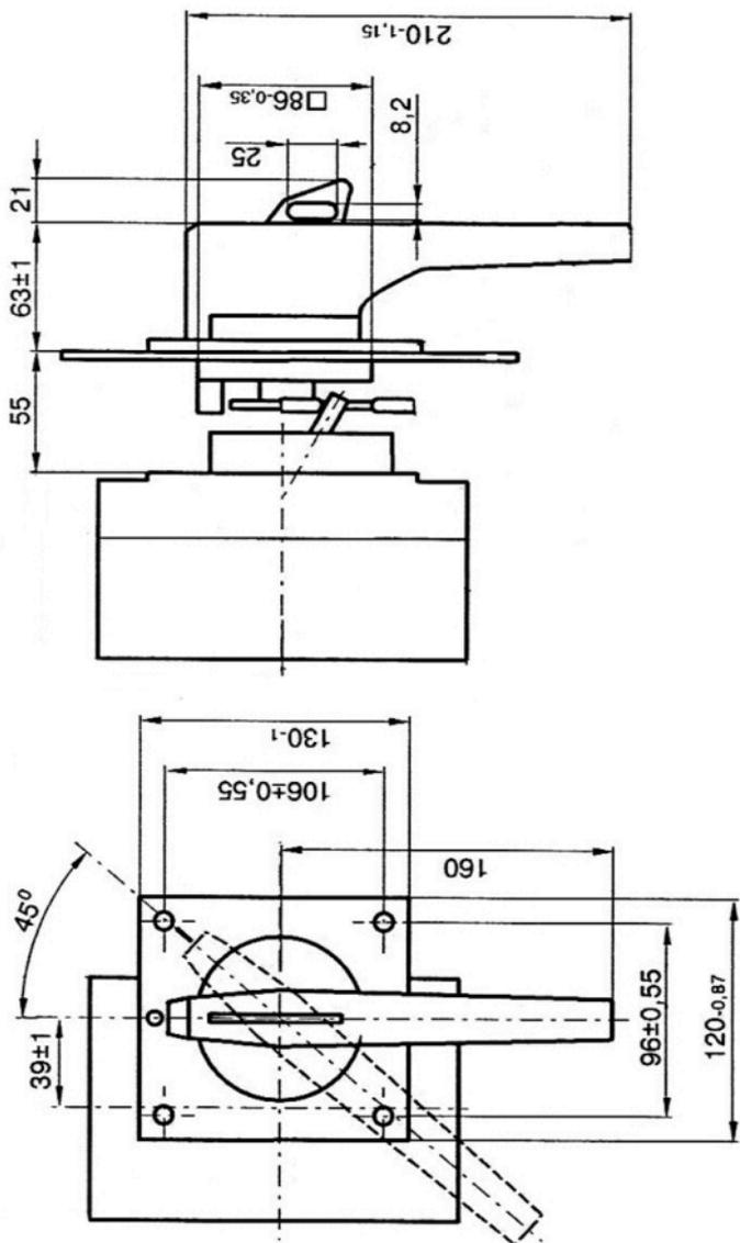
**Рисунок Б.5** - Выключатель ВА57-35 (ВА57Ф35) с ручным дистанционным приводом для оперирования через дверь распределительного устройства
