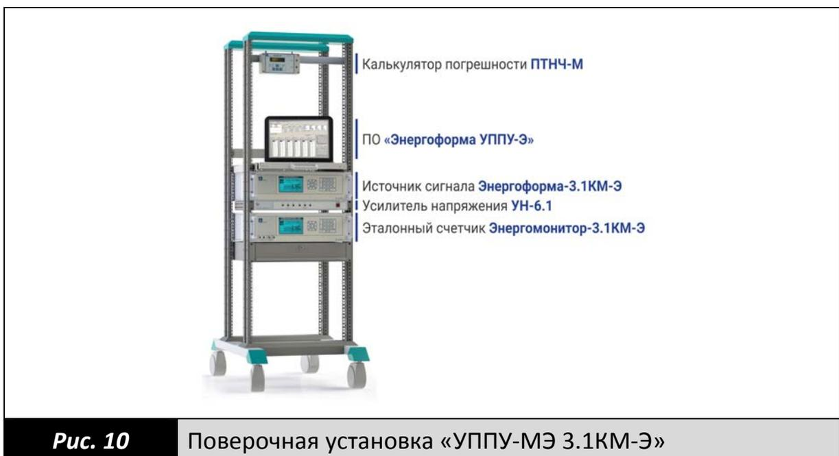
В отличие от установки для поверки традиционных электросчетчиков, диапазон входных/выходных сигналов смещен в область  $1 \text{ мВ} \div 10 \text{ В}$  как для источника сигнала, так и для эталонного счетчика. Параметры измеряемого тока передаются в виде напряжения в вышеназванном диапазоне, имитируя выходные сигналы от электронного трансформатора тока.
