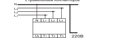
Схема подключения без применения контакторов
