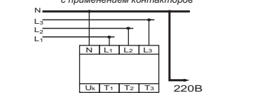
Схема подключения без применения контакторов
