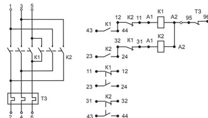
Рис. 1. Схема электрическая принципиальная нереверсивного пускателя с реле, с 2з+2р контактами вспомогательной цепи: К1 – контактор, ТЗ – тепловое реле.
