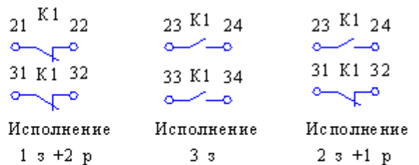
Рис. 2.4 - Пускатели непереворсивные с реле со встроенными в оболочку кнопками управления типа ПМ12-010260, ПМ12-010220 (1"з")
