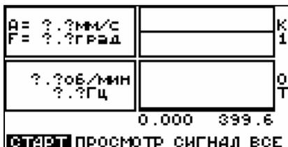
Рис 3.11 Вид экрана после выбора пользовательской конфигурации прибора для одноплоскостной балансировки, режим пауза.
