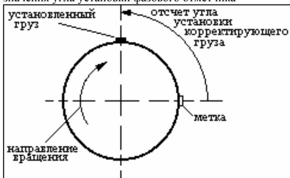
Рис.2.9.Направление отсчета положительного угла установки корректирующего груза
