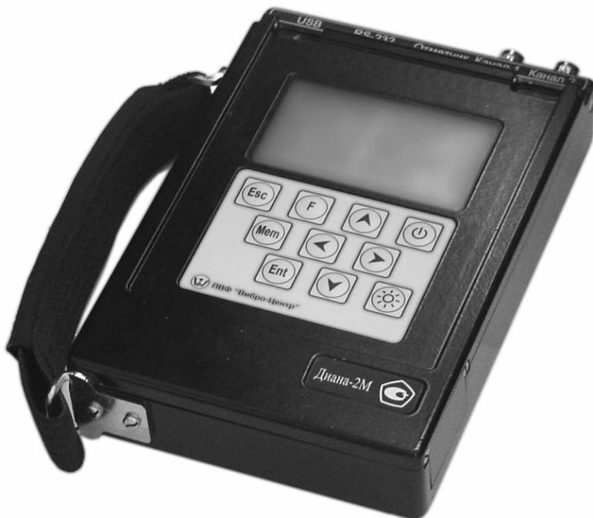
Рис.1.1. Вид на лицевую панель прибора.
