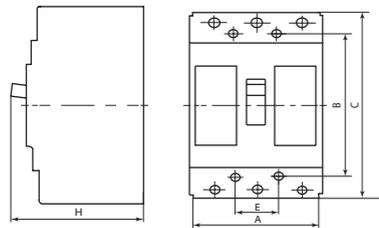
Рис. 6. Габаритные и установочные схемы ВА88
