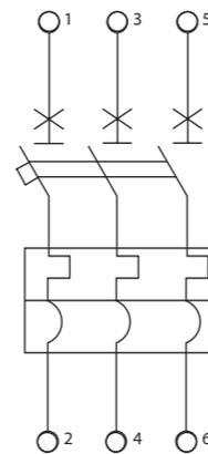
Рис. 1. Электрическая схема выключателя с тепловым и электромагнитным расцепителем
