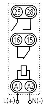
**ВНИМАНИЕ:** Для исключение сбоев в работе реле при коммутации индуктивной нагрузки (электромагнит, электромагнитный клапан и др.), подключите непосредственно к клеммам нагрузки помехоподавляющую цепь в виде последовательно соединенных резистора 100...200 Ом 2Вт и неполярного конденсатора 0.1...0.22 мкФ 630В.
