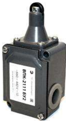
ВПК-2111-БУ2, ДВУХПОЛЮСНЫЙ, ТОЛКАТЕЛЬ С РОЛИКОМ, 1НО+1НЗ
