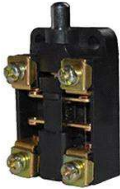
ВПК-2010-БУХЛ4, ДВУХПОЛЮСНЫЙ, ТОЛКАТЕЛЬ, БЕСКОРПУСНЫЙ, 1НО+1НЗ
