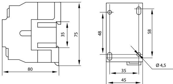
Рис. 6 - Габаритные размеры РПЛ
