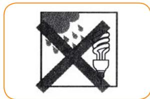
Попадание воды или снега внутрь корпуса может привести к выходу лампы из строя
