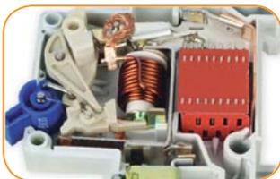
Наличие перфорированной фибровой пластины дугогасительной камеры и узкого лабиринта – щели в конструкции корпуса способствует значительному снижению температуры и плотности выхлопных ионизированных газов при коротких замыканиях
