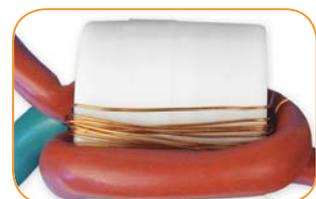
Сердечник дифференциального трансформатора изготовлен из аморфного сплава типа пермаллой, что исключает перенасыщение магнитопровода в режиме короткого замыкания
