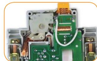
Комбинированная схема с электронным модулем дифференциальной защиты и встроенным автоматическим выключателем обеспечивает 4 вида защиты: от электропоражений; пожаров, вызванных токами утечки; короткого замыкания и перегрузки
