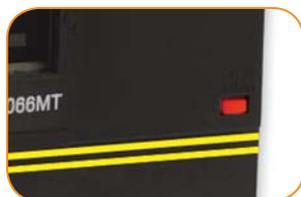
Проверка работоспособности автоматического выключателя кнопкой «ТЕСТ»
