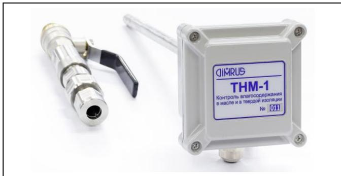
На стенке или на крышке трансформатора бака монтируется шаровой кран. На кране устанавливается переходное герметизирующее устройство, предназначенное для безопасного монтажа датчика.
